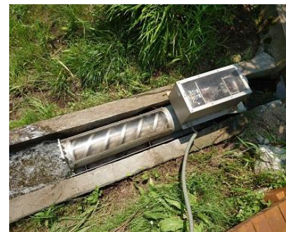
写真 農業用水路に設置されたマイクロ水力発電 出所：森町ウェブサイトより
