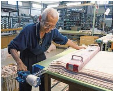
機械を使わず職人が手作業で「糸抜き」することで、端が滑らかでほつれにくいレース=写真右上=が作られる
