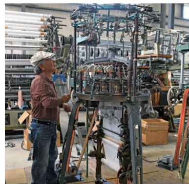
取引先の廃業により譲り受けた「丸編み機」。指導を受けながら、特殊な生産技術を継承している
