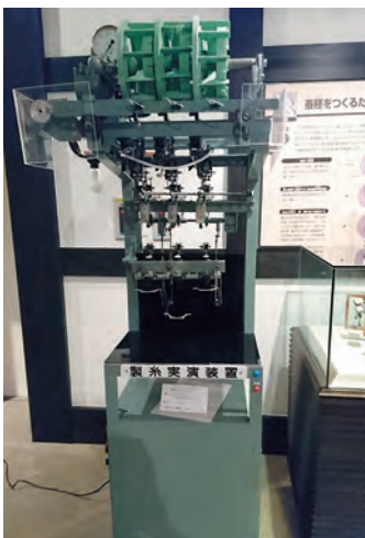
繭から糸をつくる実演にはグンゼ株式会社が保有する繰糸機が使われます
